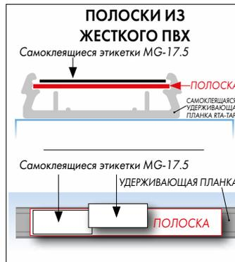
Полоски подложки идеально подходят для модульных комплектующих изделий, обеспечивая превосходное согласование с положением табличек MG-17, 5 или согласование с полосками длиной 430 мм, при нанесении непосредственно на полотно или установке в специальные профили.
