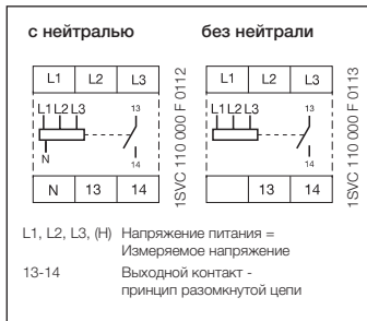
Схема подключения CM-PBE
