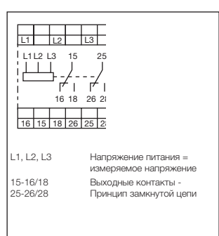
Схема подключения CM-MPN.x2
