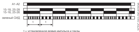
t = установленное время импульса и паузы
