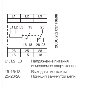
Назначение поворотного выключателя CM-PSS
