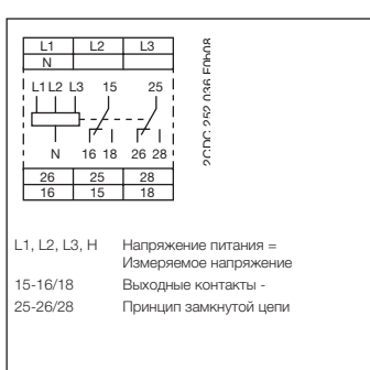
Схема подключения CM-UFS.2
