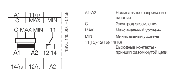
Схема подключения CM-ENS
