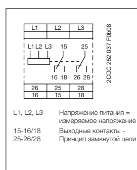
Схема подключения CM-PAS.x1
