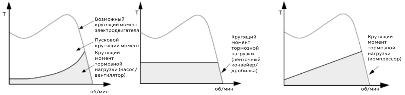
Рис. 23. Зависимость крутящего момента от частоты вращения при разной нагрузке
