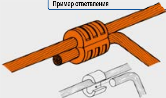
Пример соединения двух токоведущих жил
