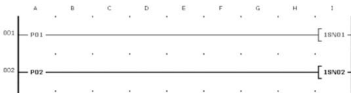
Рис. 8.48. Индикатор состояния схемы соединений подчиненной программы в устройстве 2 (при нажатии курсорной кнопки P1)
