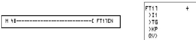
Рис. 6.63. Пример схемы соединений и дисплея настройки параметров сглаживающего фильтра FT17
