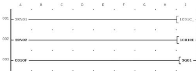
Рис. 8.46. Индикатор состояния схемы соединений главной программы на устройстве 1 (при нажатии курсорной кнопки P1 с устройства 2)
