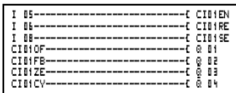
Рис. 6.21. Схема соединений счетчика приращений CI01
