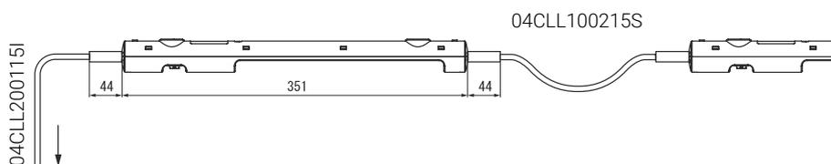
На иллюстрации показано подключение и последовательное соединение светильников CLL с помощью быстроразъемных соединителей. Защелки в разъемах обеспечивают стабильное соединение даже при сильных вибрациях. Вы можете использовать отдельно разъемы со своим кабелем для увеличения длины подключаемого кабеля.
