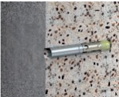
Анкерный болт тип BZ-IG Анкерный болт BZ-IG с внутренней резьбой, для нормальных неподрезанных отверстий. В рамках Европейского Технического сертификата ETA - 99/0010 для пористого и непористого бетона кроме шестигранных болтов могут использоваться болты с потайной головкой, а также системы из гаек, болтов и резьбовых стержней.
