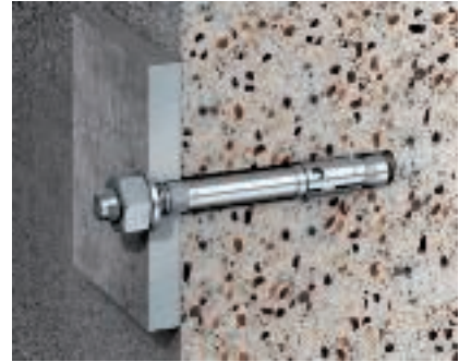
Анкерный болт тип BZ Анкерный болт тип BZ, для крепления высоких нагрузок в пористом и непористом бетоне от C20/25 до C50/60, резьбой на конце М8, М10 или М12.
