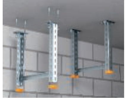
Траверса Монтаж U-образных подвесных стоек US 3 K, US 5 K и US 7 K под потолком с помощью анкерного болта и поперечной траверсы, состоящей из U-образного профиля US 3, US 5 или US 7.
