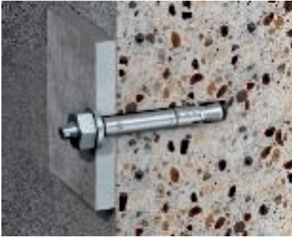
Анкер тип N с резьбой на конце Анкер тип N с резьбой М6, подходит для пористого и непористого бетона от C20/25 до C50/60.
