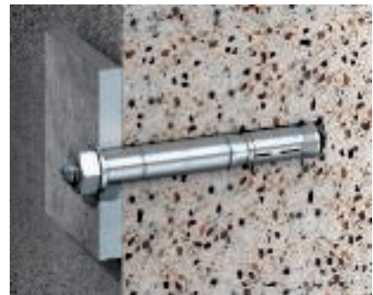
Усиленный анкер тип SZ Усиленный анкер SZ с резьбой М12, для крепления деталей при больших нагрузках, одобрен для пористого и непористого бетона C20/25 до C50/60.
