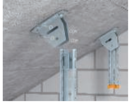
Траверса регулируемая Крепление регулируемой траверсы KU 7 VQP на наклонном бетонном потолке с помощью анкерных болтов и распорки DSK 47.
