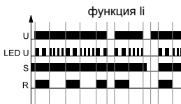
li + Ip Циклическая работа, с двумя независимыми периодами времени T1 и T2. Работа в режиме функции li или Ip зависит от положения управляющего контакта S.
