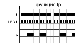
li + Ip Циклическая работа, с двумя независимыми периодами времени T1 и T2. Работа в режиме функции li или Ip зависит от положения управляющего контакта S.
