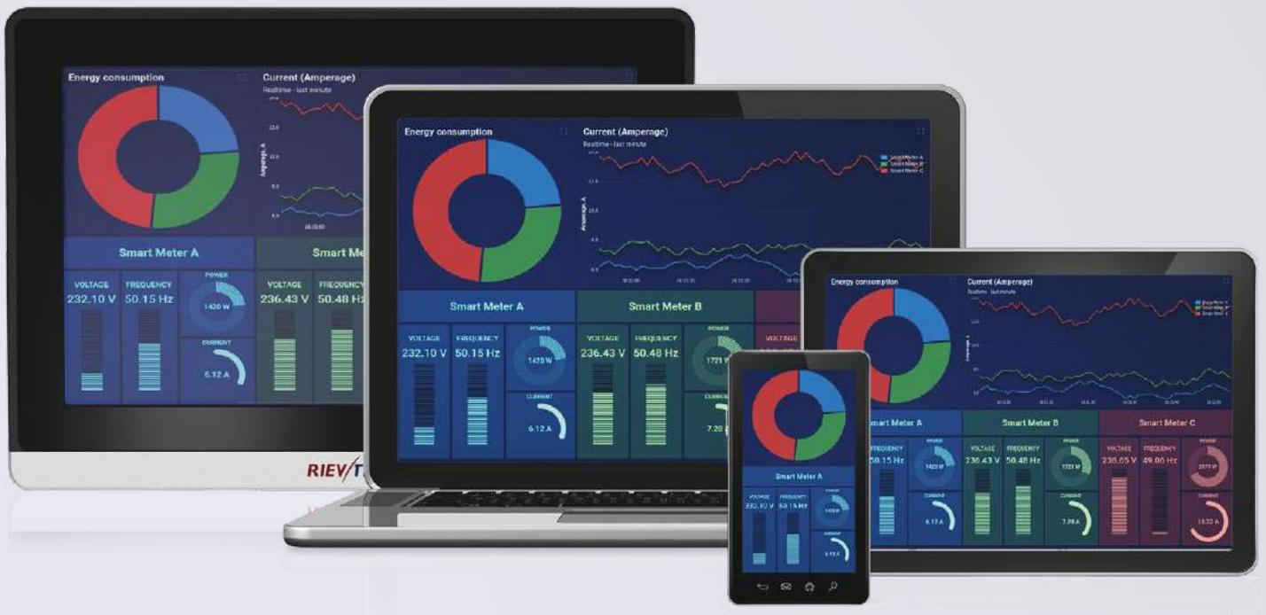
Любое портативное мобильное устройство с установленным приложением VNC-клиента может управлять панелью дистанционно. На панели оператора должна быть включена функция VNC-сервера с доступом по сети Ethernet. Мобильное устройство должно работать в режиме VNC-клиента и иметь доступ к панели оператора через локальную сеть.
