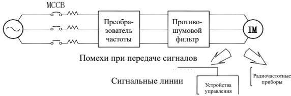
Рис. 3-7. Установка противошумового фильтра на выходе
