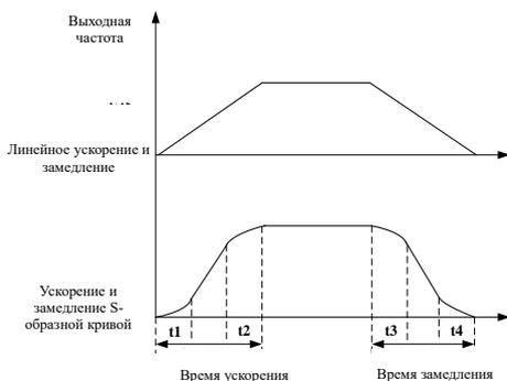
Рис. 7-16. График управления временем ускорения/замедления
