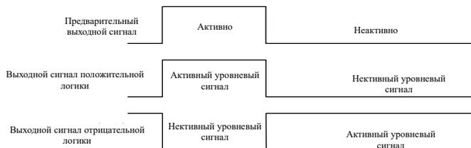
Рис. 7-14. Принципиальная схема выходных сигналов положительной и отрицательной логики цифровой выходной клеммы
