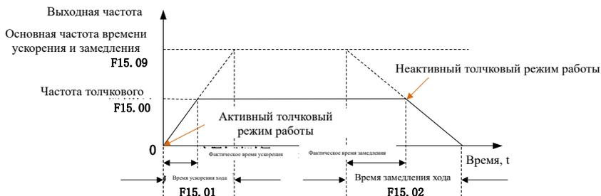
Рис. 7-32 Принципиальная схема толчкового режима работы
