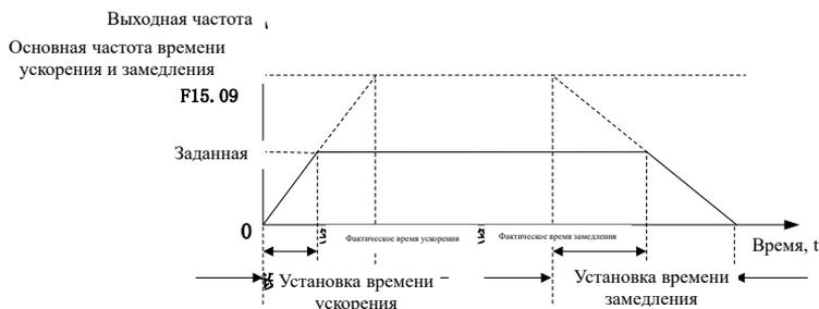
Рис. 7-33 Принципиальная схема времени ускорения и замедления
