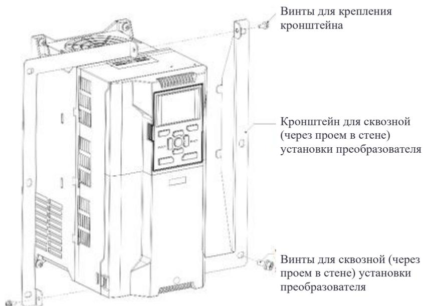
Рис. 2-6 Схема сквозной (через проем в стене) установки преобразователя (380 В) модели 0R7G/1R5P-022G/030P
