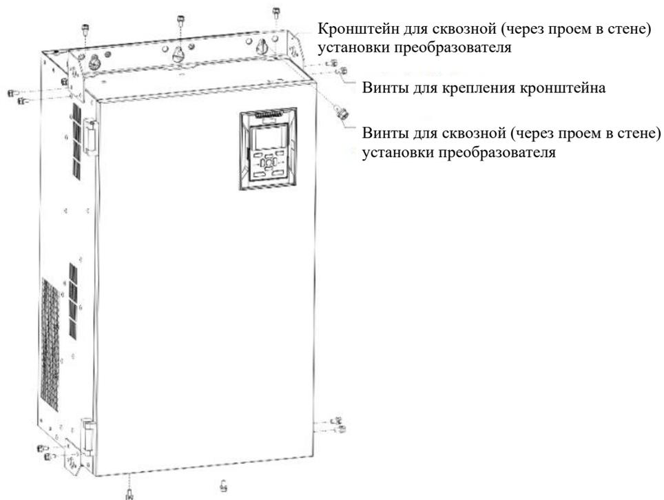
Рис. 2-8 Схема сквозной (через проем в стене) установки преобразователя (380 В) модели 132G/160P–160G/185P преобразователя (660 В) модели 160G/185P–200G/220P-6
