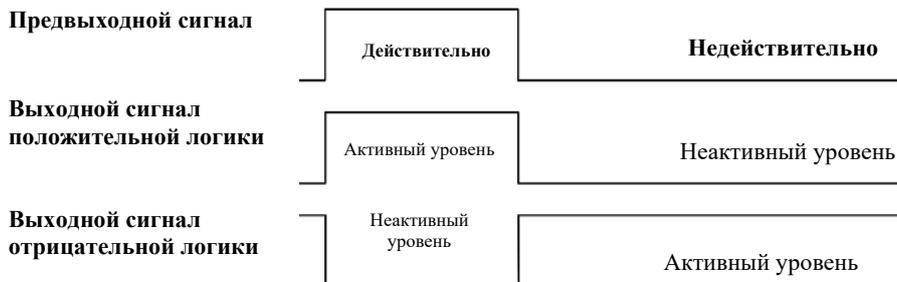
Рис. 6-23 Схема выходных сигналов положительной и отрицательной логики цифровой выходной клеммы
