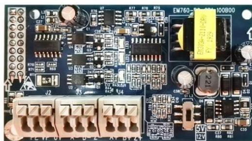
Рис. 9-6 Плата PG энкодера (дифференциального) с открытым коллектором: внешний вид изделия
