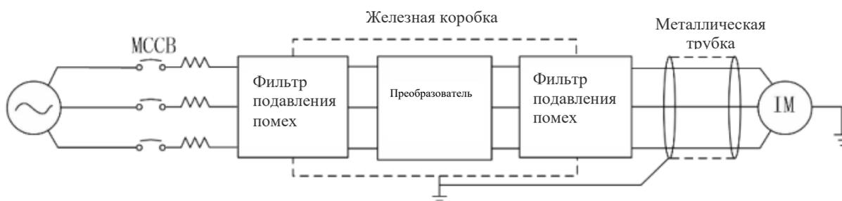
Рис. 3-14 Устранение проблемы радиочастотных помех
