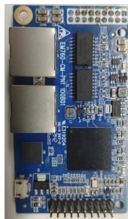
Рис. 9-26 Коммуникационная плата PROFINET: внешний вид изделия
