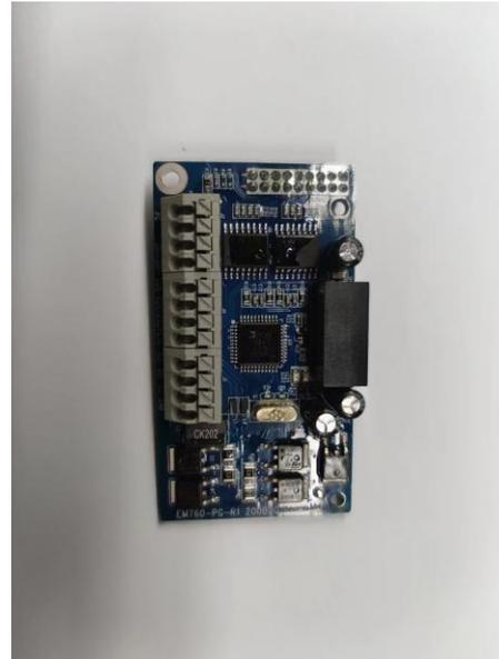
Рис. 9-20 Плата PG вращающегося (поворотного) трансформатора: внешний вид изделия
