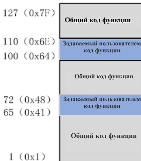
Рис. 10-3 Классификация кодов функций MODBUS
