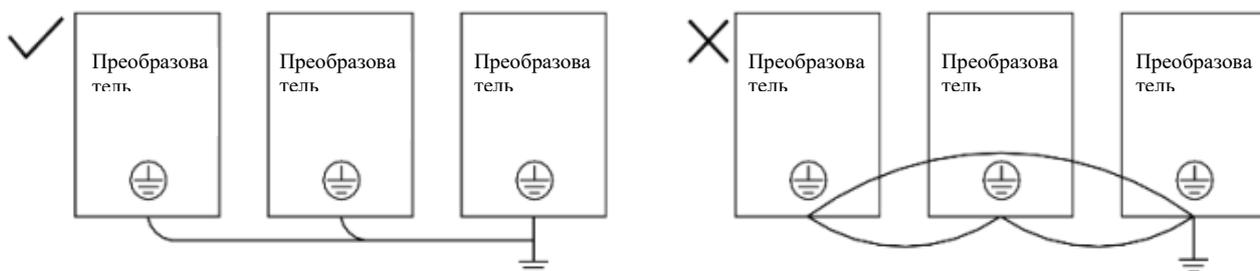
Рис. 3-15 Подключение провода заземления
