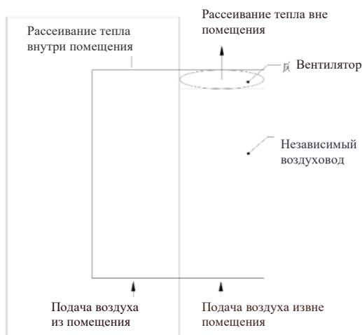
Рис. 2-5 Сквозная (через проем в стене) установка преобразователя
