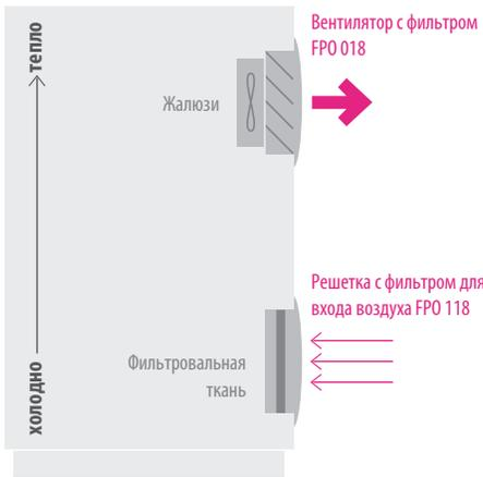
**НАПРАВЛЕНИЕ ВОЗДУШНОГО ПОТОКА "НАРУЖУ" (OUT): ВЕНТИЛЯТОР С ЖАЛЮЗИ FPO 018**
