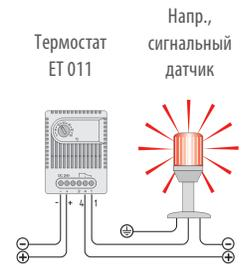
Термостат ET 011 Напр., сигнальный датчик
