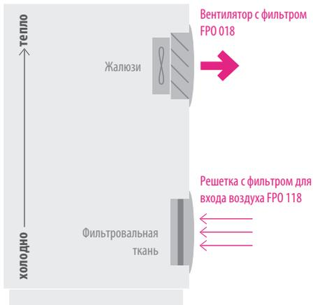
**НАПРАВЛЕНИЕ ВОЗДУШНОГО ПОТОКА "НАРУЖУ" (OUT): ВЕНТИЛЯТОР С ЖАЛЮЗИ FPO 018**
