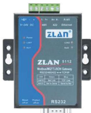
ZLAN5112 — высокопроизводительный шлюз для промышленного Интернета вещей, поддерживающий двустороннюю аутентификацию по протоколу MQTT, одновременную работу RS232 и RS485/422. Распознавание данных различных последовательных портов и передача по TCP/IP сетям, большой объем памяти. Поддержка до 1 000 точек сбора данных в JSON, высокоскоростная последовательная связь 921,6 кбит/с без потери пакетов.
