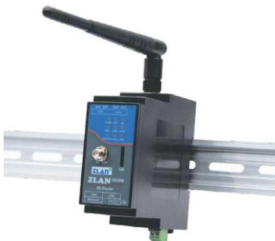
ZLAN9809M-4G — это экономичный промышленный 4G-маршрутизатор с 4 LAN-портами, интерфейсом для подключения к глобальной сети (WAN) и поддержкой Wi-Fi. Четыре порта LAN обеспечивают функцию неуправляемого коммутатора. Предусмотрен монтаж на DIN-рейку, клеммный тип питания, диапазон питающего напряжения 9–24 В.
