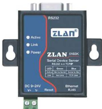
ZLAN5103K — это экономичный промышленный преобразователь интерфейсов, оснащенный интерфейсом RS232, обладающий небольшими размерами и высокой производительностью, опционально комплектуется задней направляющей.
