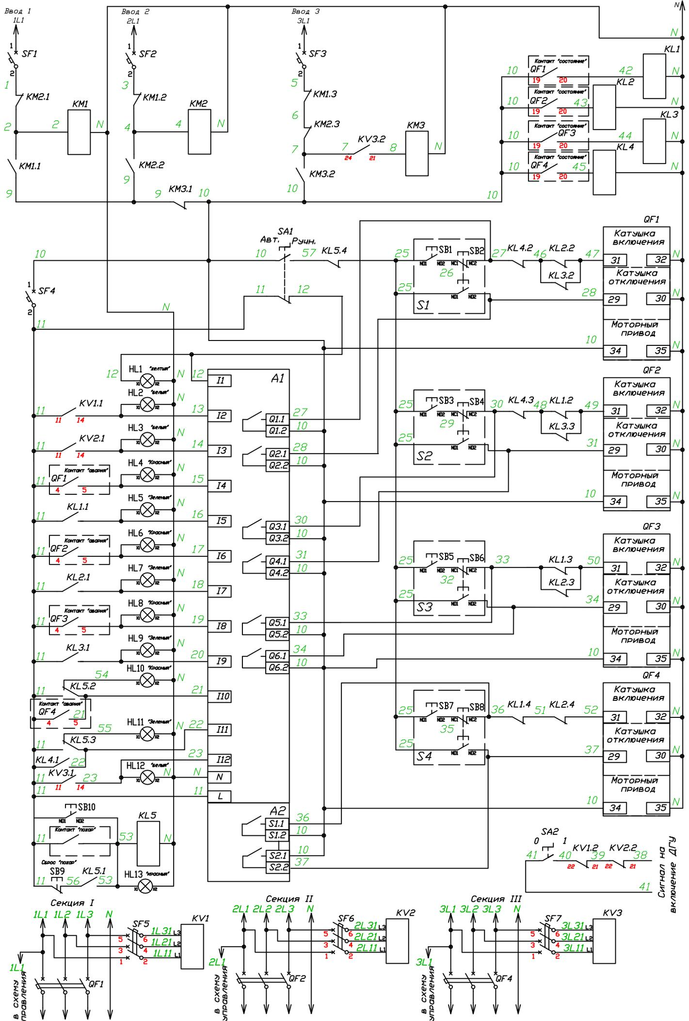
Схема подключения приводов силовых аппаратов приведена для моторных приводов CHINT для автоматов ВА-730 время завода пружины привода 3с. Маркировка клемм дополнительных контактов силовых автоматов проставлена для автоматов ВА1, для автоматов типа ВА-730 вместо 19-20 необходимо использовать 37-38, вместо 22-23 использовать 39-40.
