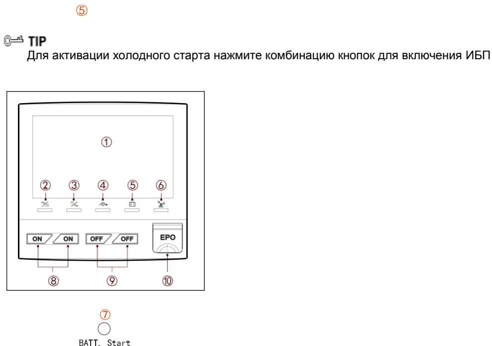
Рис 2-4 Панель управления с сенсорным дисплеем
