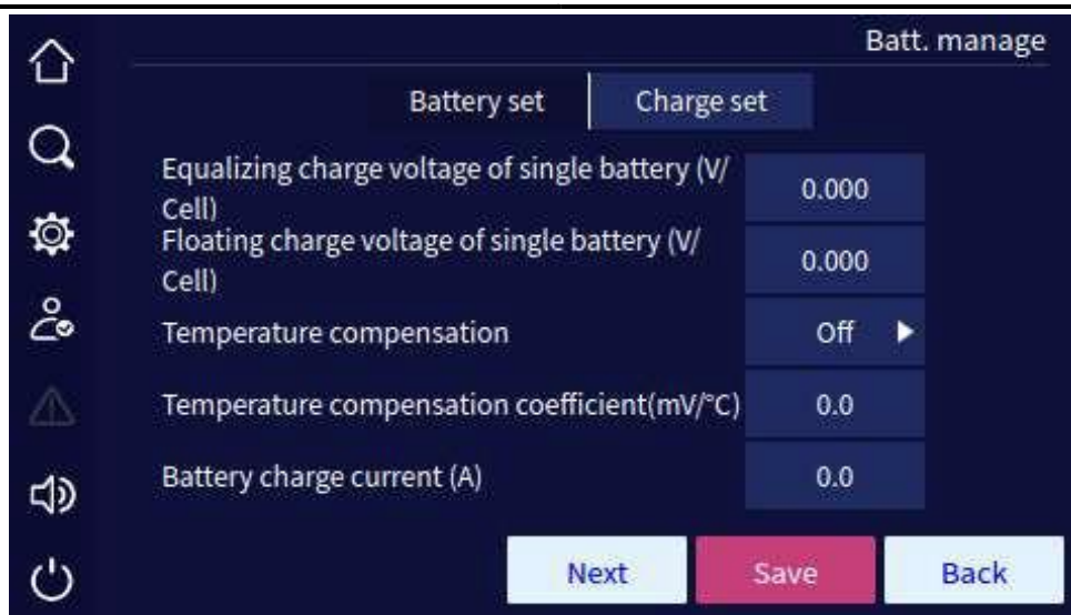
Рис 4.32 Настройка заряда АКБ 1
