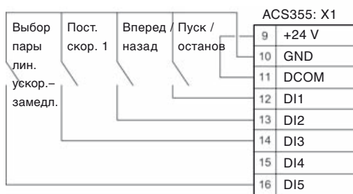
Конфигурация цифровых входов (DI) (подключение PNP) (приемник)
