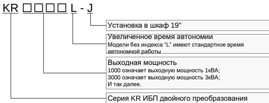
Рис 2.1 Обозначение ИБП мощностью менее 10 кВА
