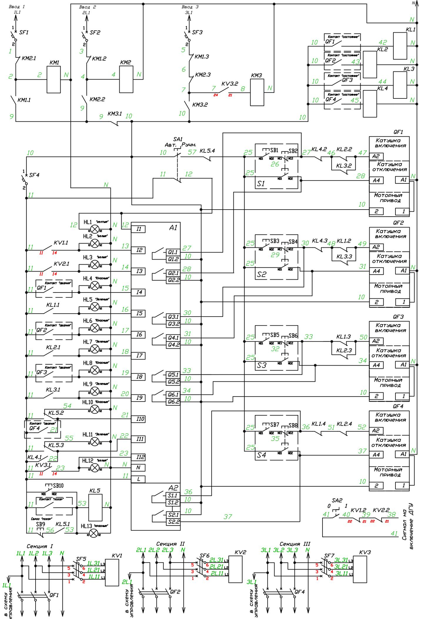
Схема подключения приводов силовых аппаратов приведена для моторных приводов GE монтажные рамы типов FD, FE, FG
