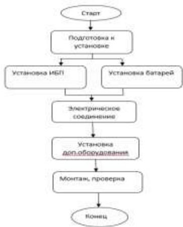
Рис3-1 Алгоритм установки ИБП
